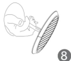
Biegen Sie das Gitter so, dass die äußeren Laschen waagrecht liegen (biegen Sie es in die Richtung, die durch die auf dem Gitter aufgedruckten Pfeile angezeigt wird).
