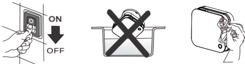
Desmontaje y limpieza del dispositivo.
