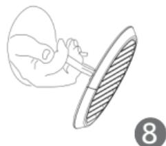
Pliez la grille de manière à ce que les languettes extérieures soient horizontales (pliez dans le sens indiqué par les flèches imprimées sur la grille).
