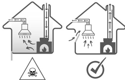
S'il n'y a pas assez d'air, une pression négative se forme. Les gaz toxiques de la cheminée ou du tuyau d'évacuation sont recirculés dans les pièces de la maison.
