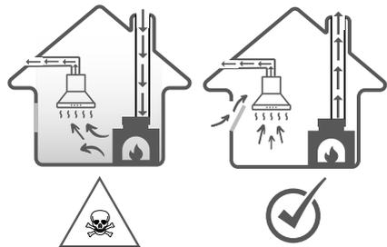
Dacă nu există o alimentare suficientă cu aer, se formează o subpresiune. Gazele toxice din coșul de fum sau din conducta de evacuare sunt recirculate în încăperile din locuință. Asigurați o alimentare suficientă cu aer atunci când folosiți unitatea în modul de evacuare a aerului și cu o sursă de încălzire dependentă de aerul din încăpere.
