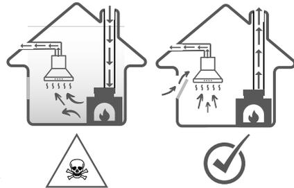
Dies kann erreicht werden, wenn die zur Verbrennung benötigte Luft durch Öffnungen, z. B. Türen, Fenster, in Kombination mit einer Zu-/Ablufteinheit oder durch andere technische Mittel zirkulieren kann. Eine Zu-/Ablufteinheit sorgt nicht selbstständig für die Einhaltung des Grenzwertes.
