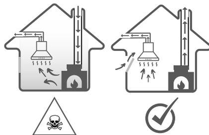
Se non c'è abbastanza alimentazione d'aria, si forma una pressione negativa. I gas tossici del camino o del tubo di scarico vengono riciccolati nelle stanze della casa.
