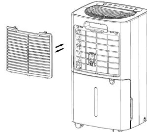
2. 2. Posizionare il filtro T-CLEAN nel telaio del filtro per un montaggio corretto.
