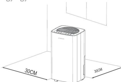
**FIGYELMEZTETÉS** - Az egységet 4 m<sup>2</sup>-nél nagyobb helyiségekben telepítse.
