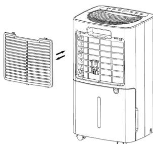
2. Puneti filtrul HEPA T-CLEAN în rama filtrului pentru montajul corect al acestuia.
