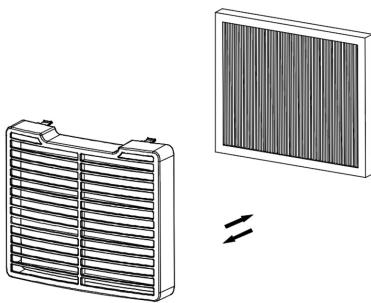
3. Montati pe unitate filtrul T-CLEAN cu rama
