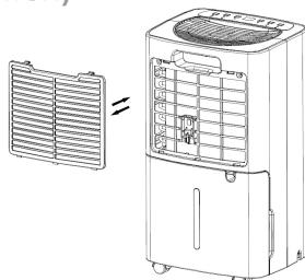
2. Setzen Sie den HEPA-T-CLEAN Filter zur korrekten Befestigung in den Filterrahmen ein.
