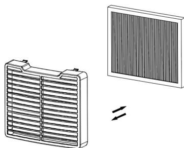
3. Montieren Sie den T-CLEAN-Filter mit dem Rahmen am Gerät
