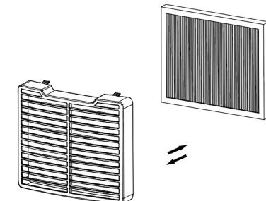
3. Montez le filtre T-CLEAN avec le cadre sur l'appareil
