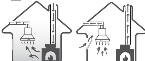
Bei zu geringer Luftzufuhr entsteht ein Unterdruck. Giftige Gase aus dem Schornstein oder dem Auspuffrohr werden in die Räume des Hauses zurückgeführt.
