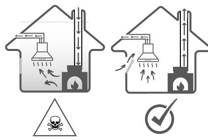
Si no hay suficiente suministro de aire, se forma una presión negativa. Los gases tóxicos de la chimenea o del tubo de escape se recirculan en las habitaciones de la casa.
