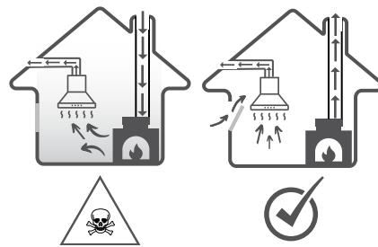
Se non c'è abbastanza alimentazione d'aria, si forma una pressione negativa. I gas tossici del camino o del tubo di scarico vengono ricircolati nelle stanze della casa.
