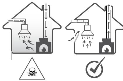
S'il n'y a pas assez d'air, une pression négative se forme. Les gaz toxiques de la cheminée ou du tuyau d'évacuation sont recirculés dans les pièces de la maison.
