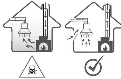
Si no hay suficiente suministro de aire, se forma una presión negativa. Los gases tóxicos de la chimenea o del tubo de escape se recirculan en las habitaciones de la casa.
