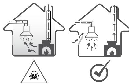
Dacă nu există o alimentare suficientă cu aer, se formează o subpresiune. Gazele toxice din coșul de fum sau din conducta de evacuare sunt recirculate în încăperile din locuință.
