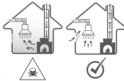
Bei zu geringer Luftzufuhr entsteht ein Unterdruck. Giftige Gase aus dem Schornstein oder dem Auspuffrohr werden in die Räume des Hauses zurückgeführt. Sorgen Sie bei Betrieb des Gerätes im Abluftbetrieb und bei raumluftabhängiger Heizquelle für ausreichende Luftzufuhr.
