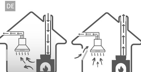
Bei zu geringer Luftzufuhr entsteht ein Unterdruck. Giftige Gase aus dem Schornstein oder dem Auspuffrohr werden in die Räume des Hauses zurückgeführt.
